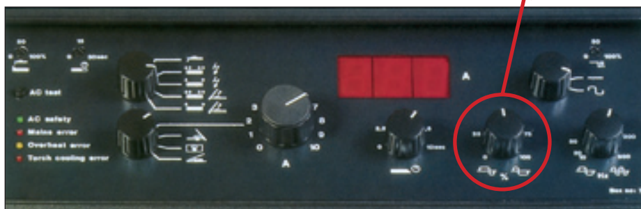
Svářeč jen na panelu změnil potřebný poměr kladné půlvy vůči záporné a svařovací stroj např. zvýšil čistící efekt pro odstranění oxidu hliníku z povrchu lázně, případně jej snížil podle potřeby.
