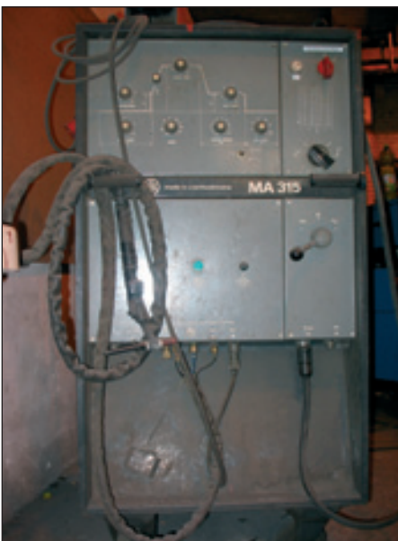
Svařovací stroje pro metodu TIG AC/DC o výkonu kolem 300 A byly v 80. letech minulého století velké přibližně jako obrovská „šatní skříň“ a jejich hmotnost přesahovala 600 kg.
