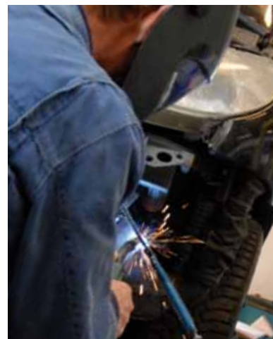
MIG pájení zachovává pevnost oceli a chrání antikorozní zinkový povrch
