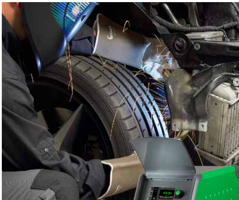
Řídicí jednotka MJCTM umožňuje uložit až 200 jednotlivých svařovacích operací
