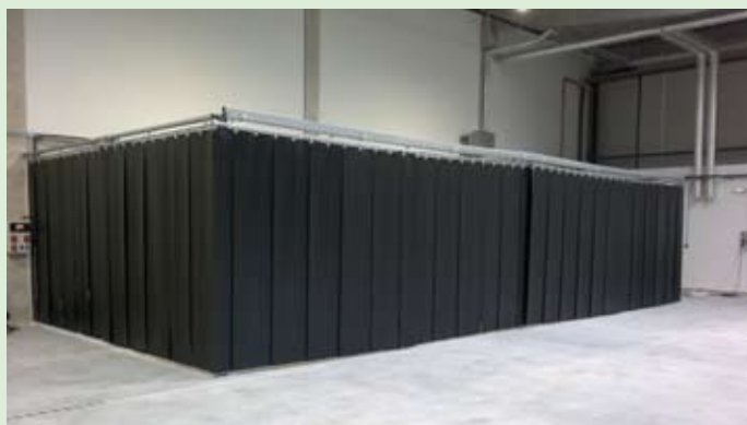
Podobně jako svařovací zástěny lze pro účinné zastínění svařovacího boxu použít svařovací lamely.
