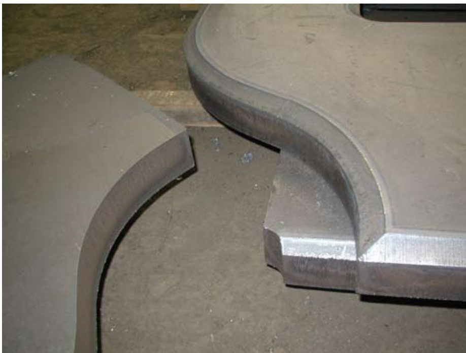
Řezání tvarového úkosy kyslíkem na připraveném výpalku.
