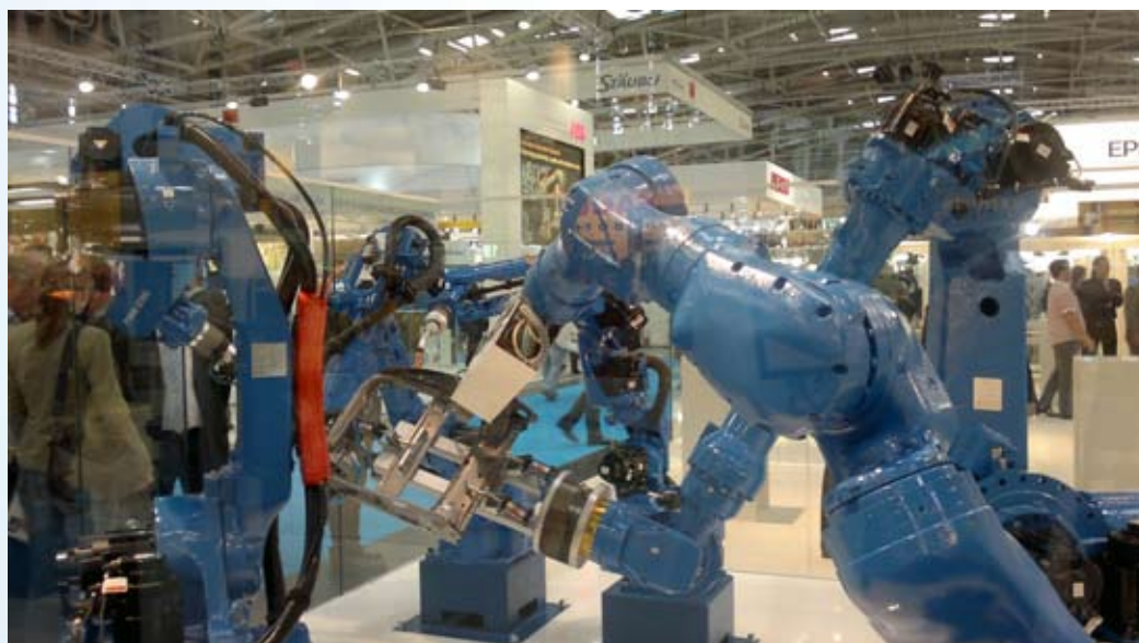
Pět robotů Motoman provádí různé operace. Od manipulace, přes svařování, až po testování jakosti svarů.
