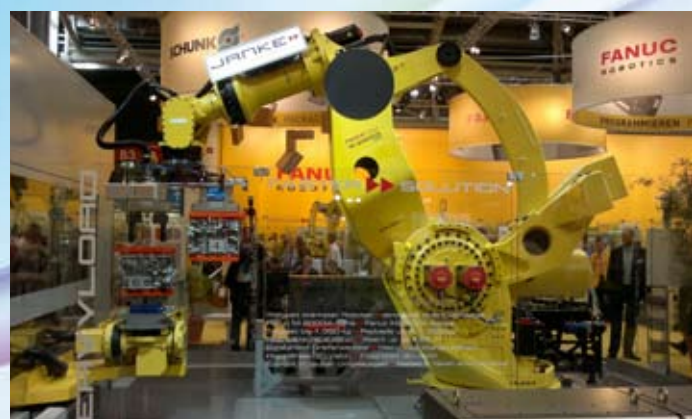
Zaujal nás obří šestiosý robot Fanuc s max. nosností 1 350 kg.
