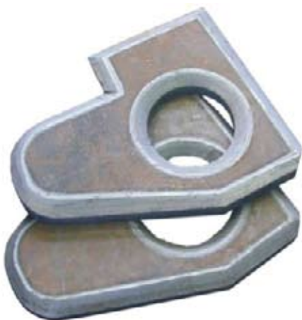
Typický představitel dílce s úkosy jako příprava ploch pro svařování.
