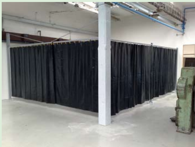
Optimálně zastíněný svařovací box svařovacími zástěnami tmavě zelené barvy. Tento odstín má nejvyšší stupeň zatemnění, tedy 9.
