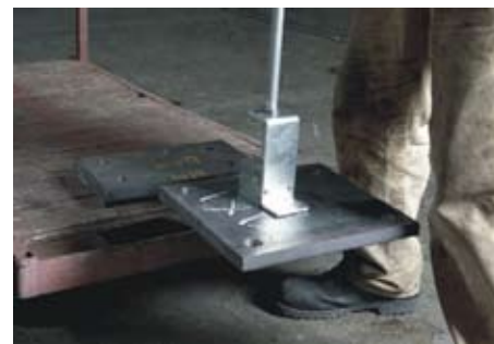
Magnetický manipulátor s max. nosností 32 kg.
