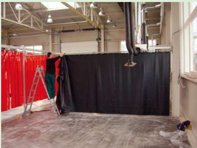
Svařovací zástěny jsou vybaveny oky pro uchycení na ocelovou konstrukci. Po obou stranách zástěn jsou nalisované zapínací knoflíky, pomocí kterých lze jednotlivé zástěny na sebe vzájemně napojovat.
