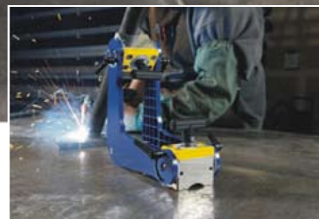
Nastavitelná magnetická úchytka Boomer umožňuje polohování svařovaných dílců pod různými úhly dle potřeby.
