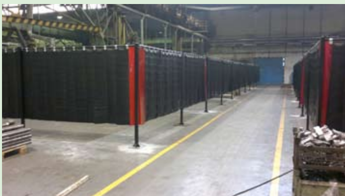
U jednoho zákazníka jsme instalovali lamelové stěny s tím, že v rozích byla použita jedna červená lamela. Přes červenou lamelu lze sice omezeně do vnitřního prostoru svařovacího boxu nahlédnout, aniž by pracovník musel do prostoru svařování vstoupit.
