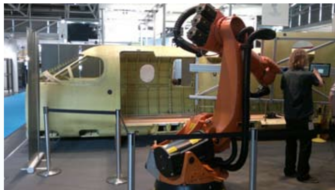
V jednom stánku byl umístěn nedokončený skelet malého dopravního letadla. Pomocí průmyslového robota se postupně přesně přikládají k rozestavěné kostře letadla další části trupu, které pak obsluha montuje.
