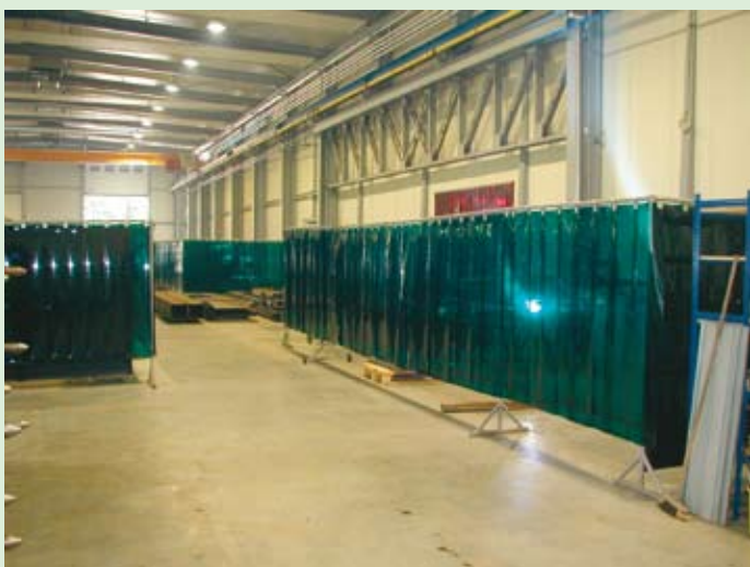
Další příklad zastínění svařovny pomocí svařovacích lamel. Tmavě zelená barva svařovacích lamel zajišťuje nejvyšší úroveň ochrany okolních pracovišť proti škodlivému záření od svařování.
