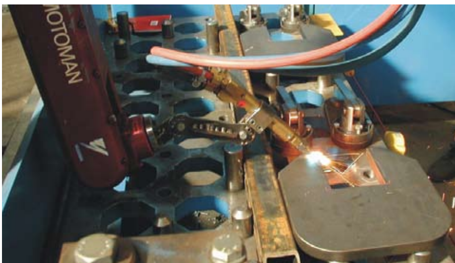
Řezanou hranu dílce není potřeba dále brousit, postačí pouze kladívkem oklepat strusku.
