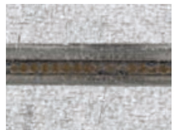
Pozinkovaný ocelový plech – tavná plasma na tloušťce 0,5 mm
