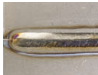
Nerezová ocel – průvarová plasma na tloušťce 6 mm
