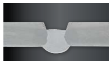
Kořenová vrstva v nízkouhlíkové oceli o tloušťce 5 mm prořezaná shora dolů za použití programu IAC TM .
