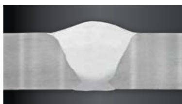
Kořenová vrstva v nízkouhlíkové oceli o tloušťce 10 mm prořezaná shora dolů za použití programu IAC TM ; vyplněna dvěma vrstvami shora dolů.
