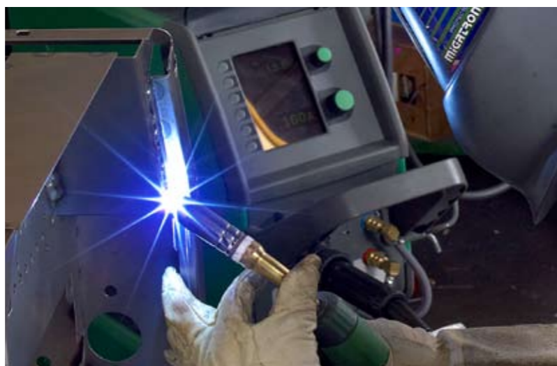
Ve svařovacím stroji Sigma Galaxy je výkonný počítač, který upravuje parametry procesu až 50 000krát za sekundu.
