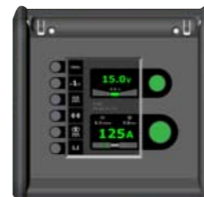
Ovládací panel obsahuje programovatelná tlačítka doplněná intuitivními grafickými ikonami.
