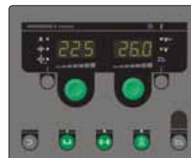
Omega 2 Advanced je synergický panel s funkcí DUO Plus™ pro svary podobné TIG svařům a pro přesné řízení taveniny. Řídicí panel Advanced má programy pro profesionální průmyslové svařování a MIG pájení uhlíkových ocelí, nerezových ocelí a hliníku plnými i trubičkovými dráty.
