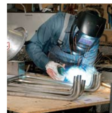
Výroba armatur pro potravinářský průmysl metodou DUO Plus™ z nerezavějící oceli.
