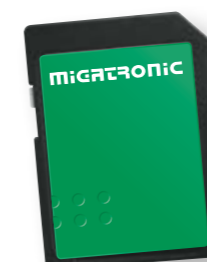
Čtečka SD paměťové karty je umístěna v bezpečí uvnitř skříně podavače drátu a je určena pro snadné budoucí aktualizace programů a řídicího software stroje.
