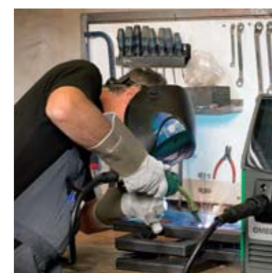
Svařování profilů pro konstrukci kovového nábytku.
