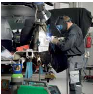
MIG pájení C sloupku
